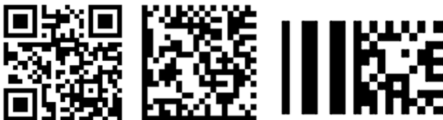
รูปที่ 2 แสดงตัวอย่างบาร์โค้ด 2 มิติ ประเภท QR Code [1] (ซ้าย) Data Matrix [2] (กลาง) และ InterCode [3] (ขวา)
